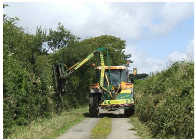
Abbildung 2: Maschineller seitlicher Pflegeschnitt einer Hecke (© Jonathan Billinger (cc-by-sa/2.0)).
